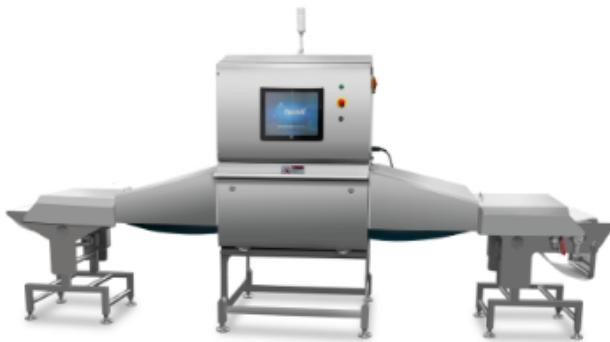
Подходит для поточного нахождения остаточных фрагментов костей при переработке мяса. На данной машине не устанавливаются защитные освинцованные шторки, чтобы обеспечить гигиеническую чистоту. Для защиты персонала от излучения используются длинные защитные кожуха, а также зона детектирования находится выше уровня входа и выхода продукции.
