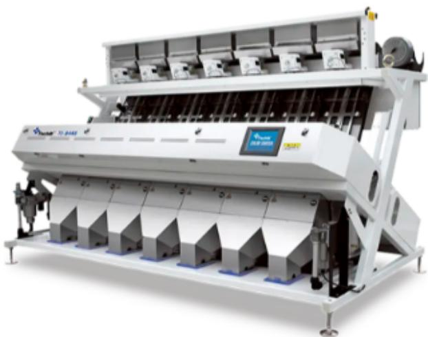
Индивидуально настроенный промышленный широкоугольный объектив, сверх чёткие CCD сенсоры с разрешением 5400 пикселей обеспечивают улучшенное изображение. Сочетание сортировки по цвету и сортировки по форме обеспечивает максимальную точность сортировки.
